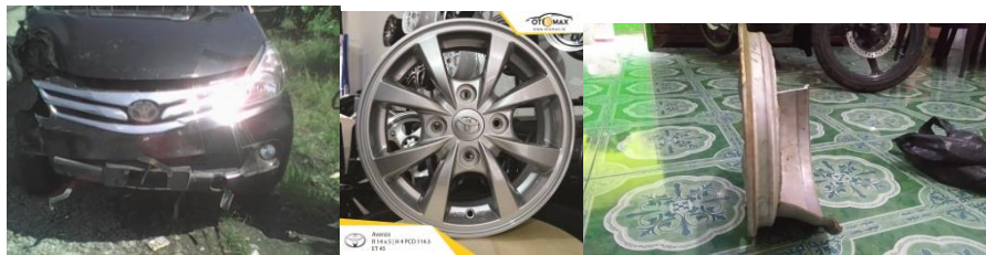
Gambar.2.Pelek Mobil Avanza Kerusakan Akibat terjadinya Tubrukan
